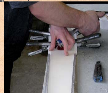
Sicherung der Schichten. Securing laminations for press. Фиксирование лыжи.
